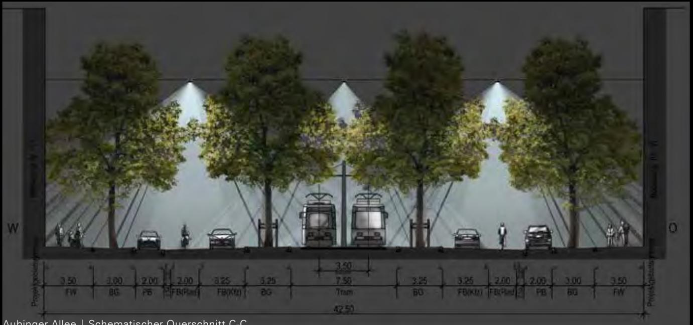
Aubinger Allee | Schematischer Querschnitt C-C
