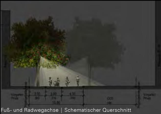
Fuß- und Radwegachse | Schematischer Querschnitt
