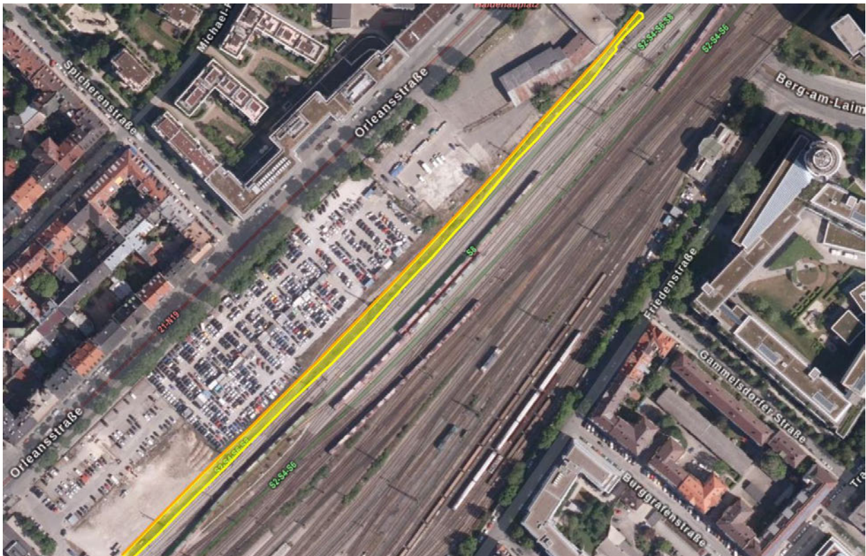
Abb. 4: Schematische Darstellung des Bahnpflegewegs (gelbe Fläche) und des nordwestlich aufzustellenden stabilen Schutzzaunes (orange Linie).
