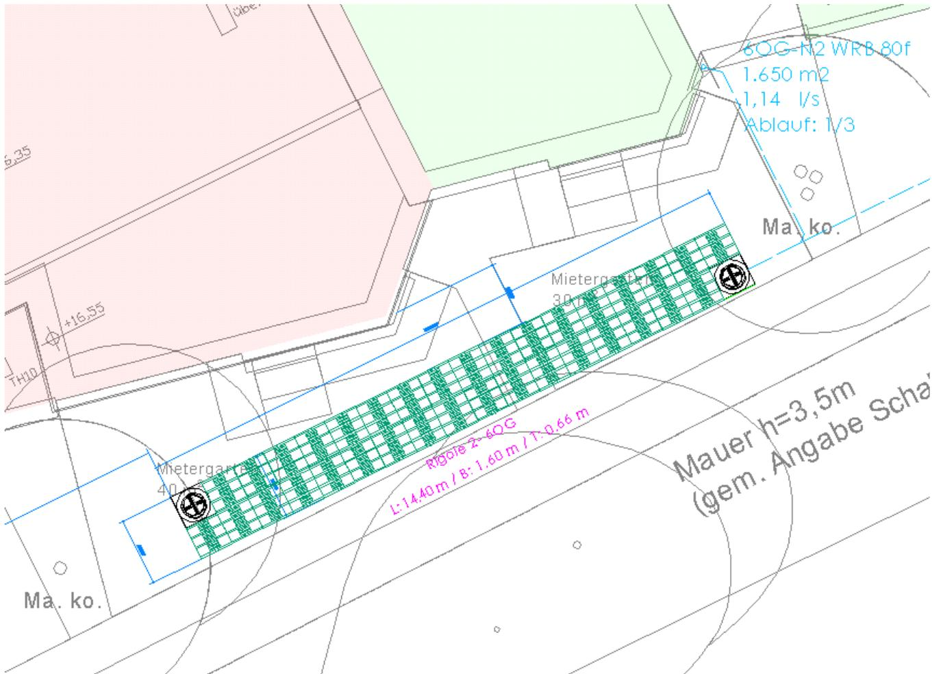
Bild Nr. 3: Rigole 2- 6OG (L: 14,40 m / B: 1,60 m / T: 0,66 m)
