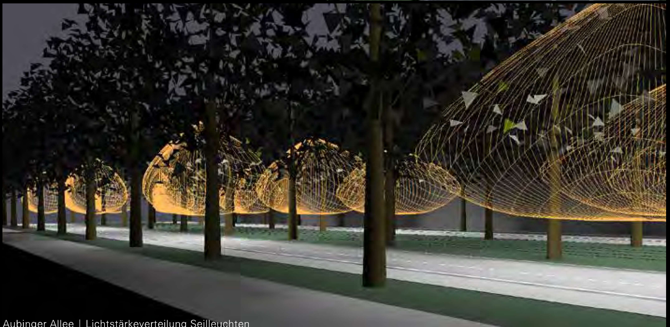
Aubinger Allee | Lichtstärkeverteilung Seilleuchten
