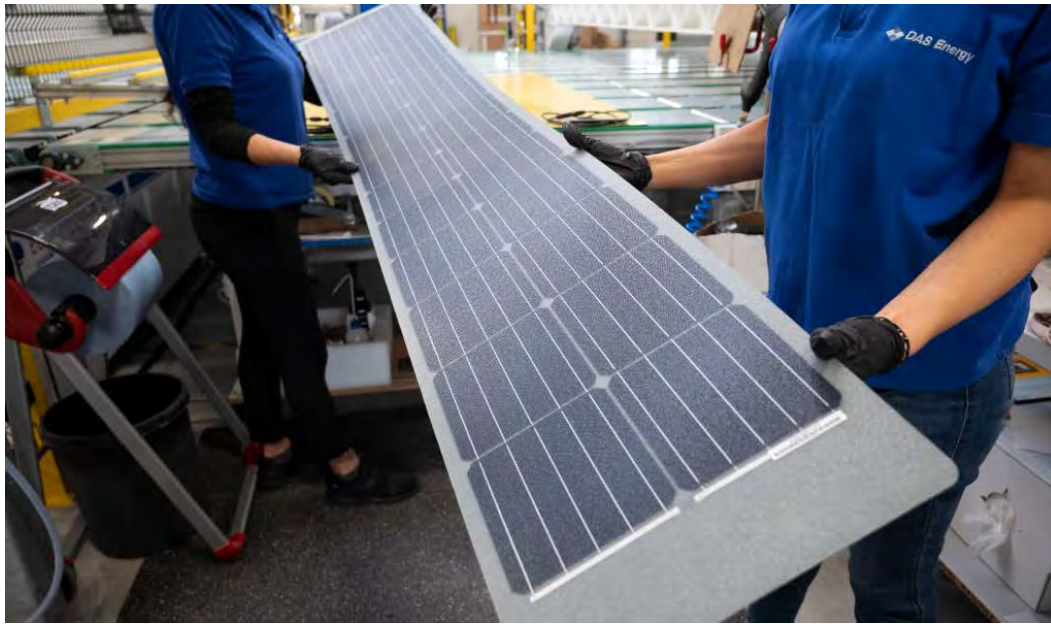
Links: Leichtbaumodul mit 3,3 kg/m 2 , rechts: Montage (© DAS Energy)
