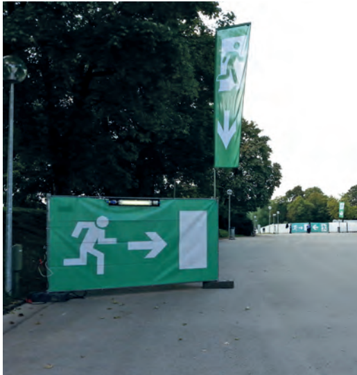
Abb. 30: Ergänzende Kennzeichnung eines Fluchtweges durch eines Flagge
