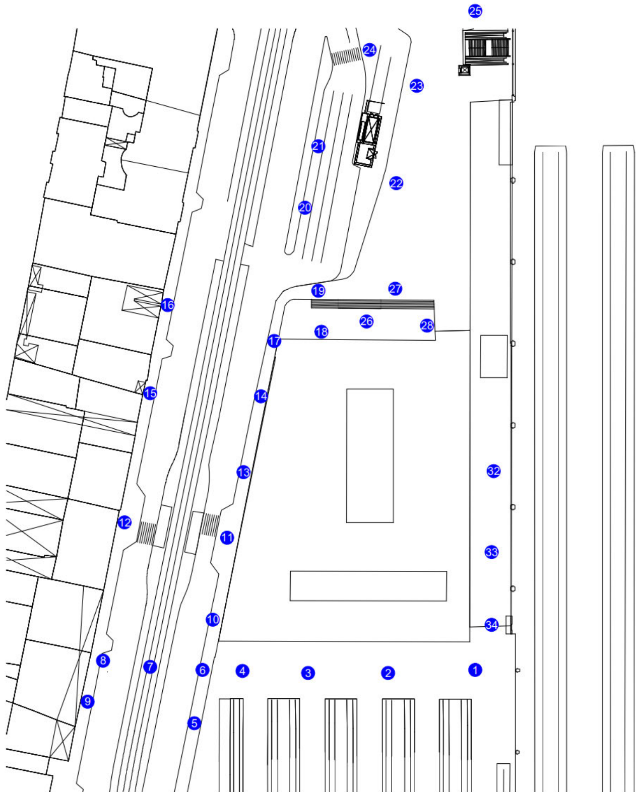
Abb. 2.7: Bezeichnungen und Positionen der Messstellen der Windkomfortmessung im bodennahen Außenbereich – Konfiguration 1: Istzustand
