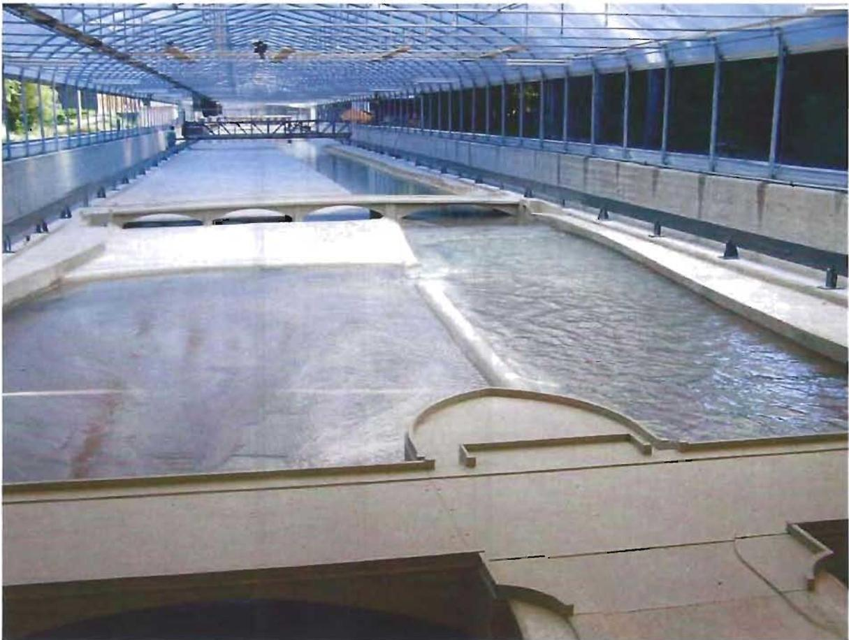
Abb. 13: Blick von der Museumsinsel flussaufwärts, Abflusssimulation eines 1-jährlichen Hochwassers (Ist-Zustand)
