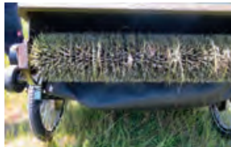
Die rotierenden Bürsten werden elektrisch angetrieben.
