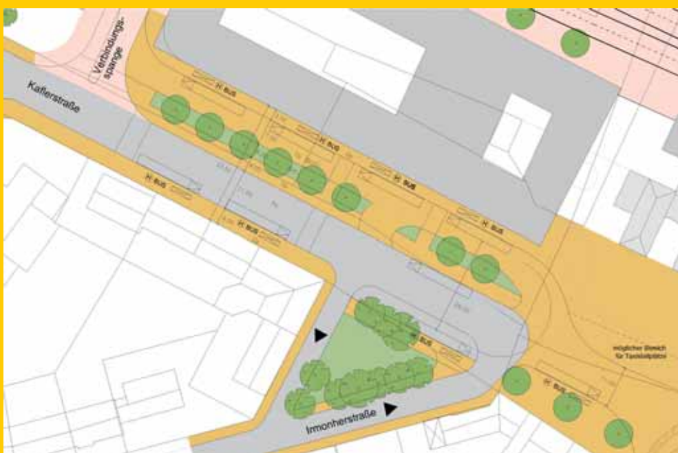
Beispiel 01: halbbintegrierte Seitenbahnsteige
