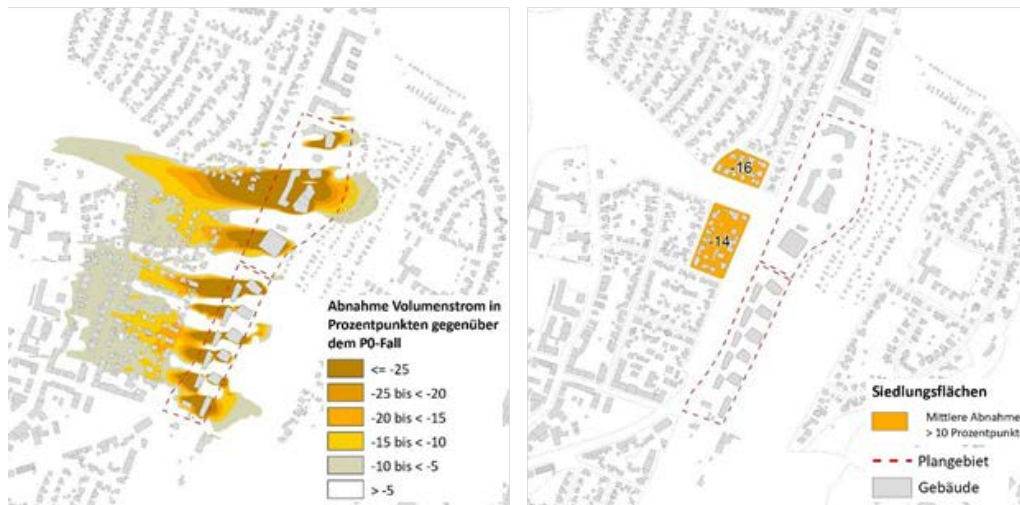
Abb. 8 Differenz Kaltluftvolumenstrom in Prozentpunkten gegenüber dem P0-Fall (links) und mittlere Abnahme des Kaltluftvolumens innerhalb betroffener Blockflächen in der Variante 7d - 3 (rechts)
